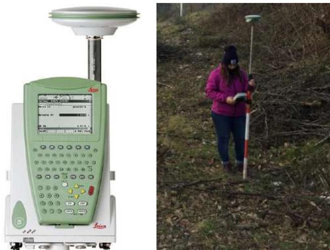
Figura 6 - Ricevitore GNSS Leica 1200 e rilievo GPS.
