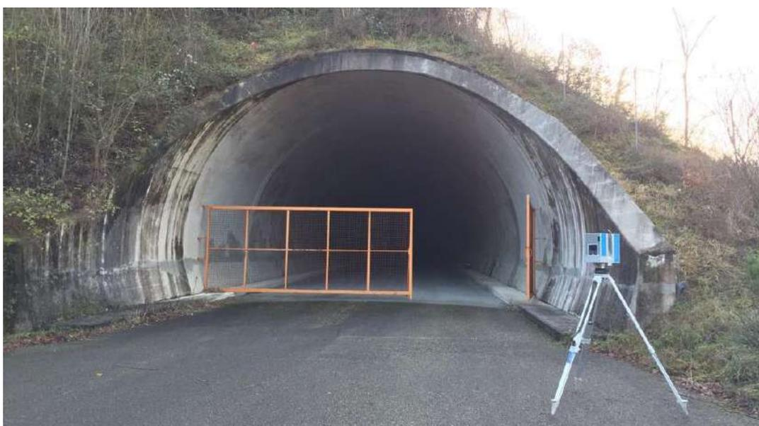
Figura 18 –Laser scanner RIEGL VZ-400i durante il rilievo della galleria S.Antonio.
