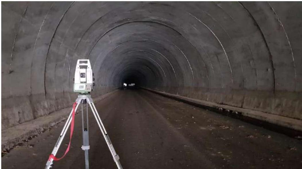
Figura 8 –Stazione totale Leica TS60 durante il rilievo della galleria Sant'Antonio seconda canna.
