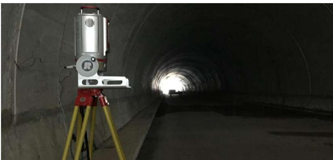
Figura 17 –Laser scanner RIEGL VZ-400i durante il rilievo della galleria Valpiana.
