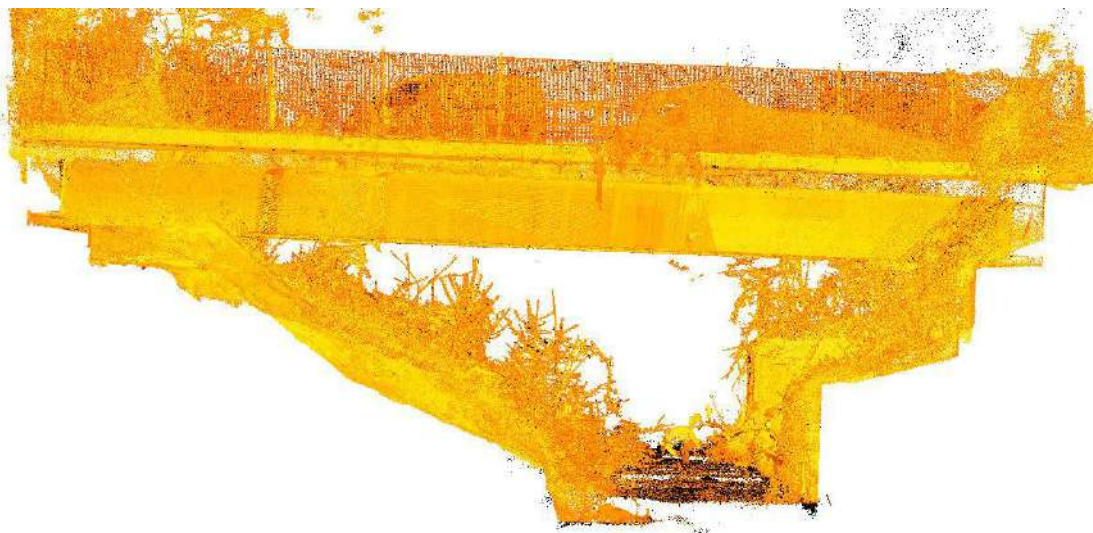
Figura 11 – Nuvola di punti tridimensionali del prospetto ovest dell'impalcato.
