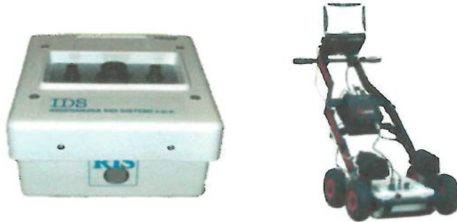
Figura 3 - Esempio di box dual frequency e configurazione G.P.R. utilizzata
