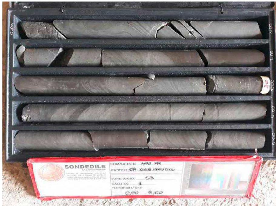
Figura 5.10 – Esempio di carote recuperate nei sondaggi in galleria.
