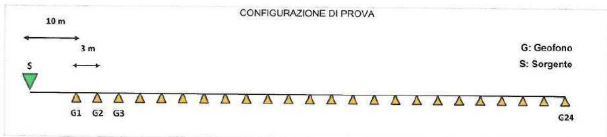
Figura 5.6 - M.A.S.W. Mercatello: ubicazione e dettagli di acquisizione.
