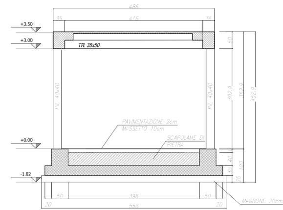
**SEZIONE SOLAIO q.3.50**
