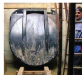
VOCE DI CAPITOLATO : Fornitura di valvola antiriflusso fine linea costruita in poliestere rinforzato e gel-cot isoaltalico , metallerie in acciaio inox AISI 316 , flangiata per accoppiamento a parete verticale ; battente inclinato ; tenuta idraulica 1 bar ; guarnizione di tenuta in EPDM
