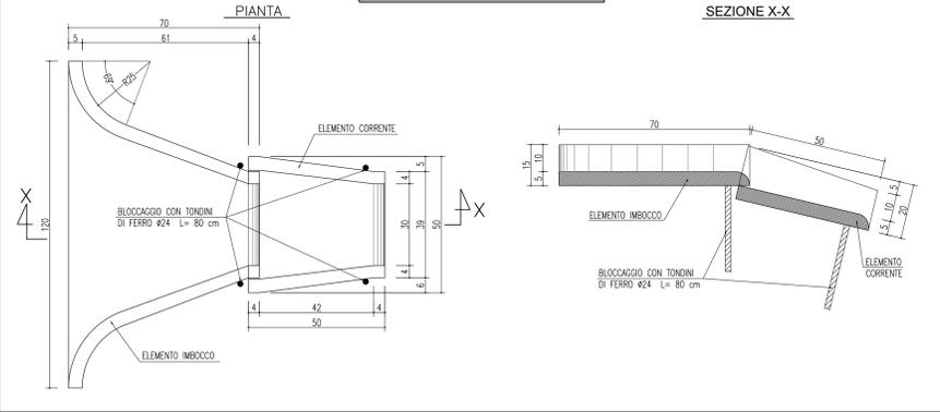
SEZIONE TIPO IN BANCHINA LATO BARRIERA FONOASSORBENTE - PARTICOLARE D
