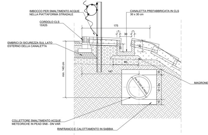
SEZIONE TIPO IN TRINCEA - MARGINE ESTERNO - SEZIONE POZZETTO DI LINEA/SCARICO e ISPEZIONE - PARTICOLARE A
