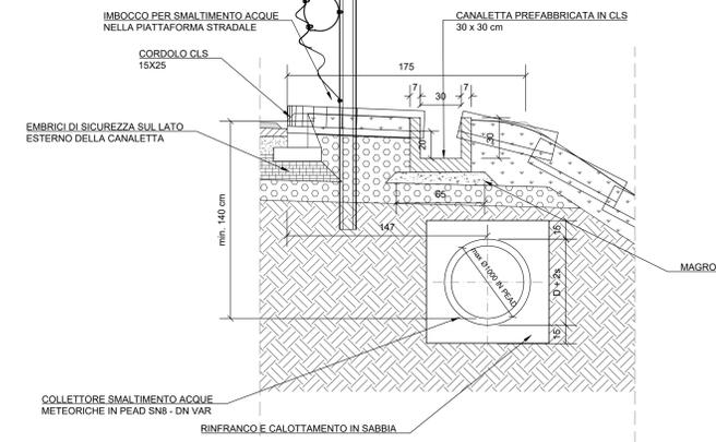
SEZIONE TIPO IN TRINCEA - MARGINE ESTERNO - SEZIONE POZZETTO DI LINEA/SCARICO e ISPEZIONE - PARTICOLARE A
