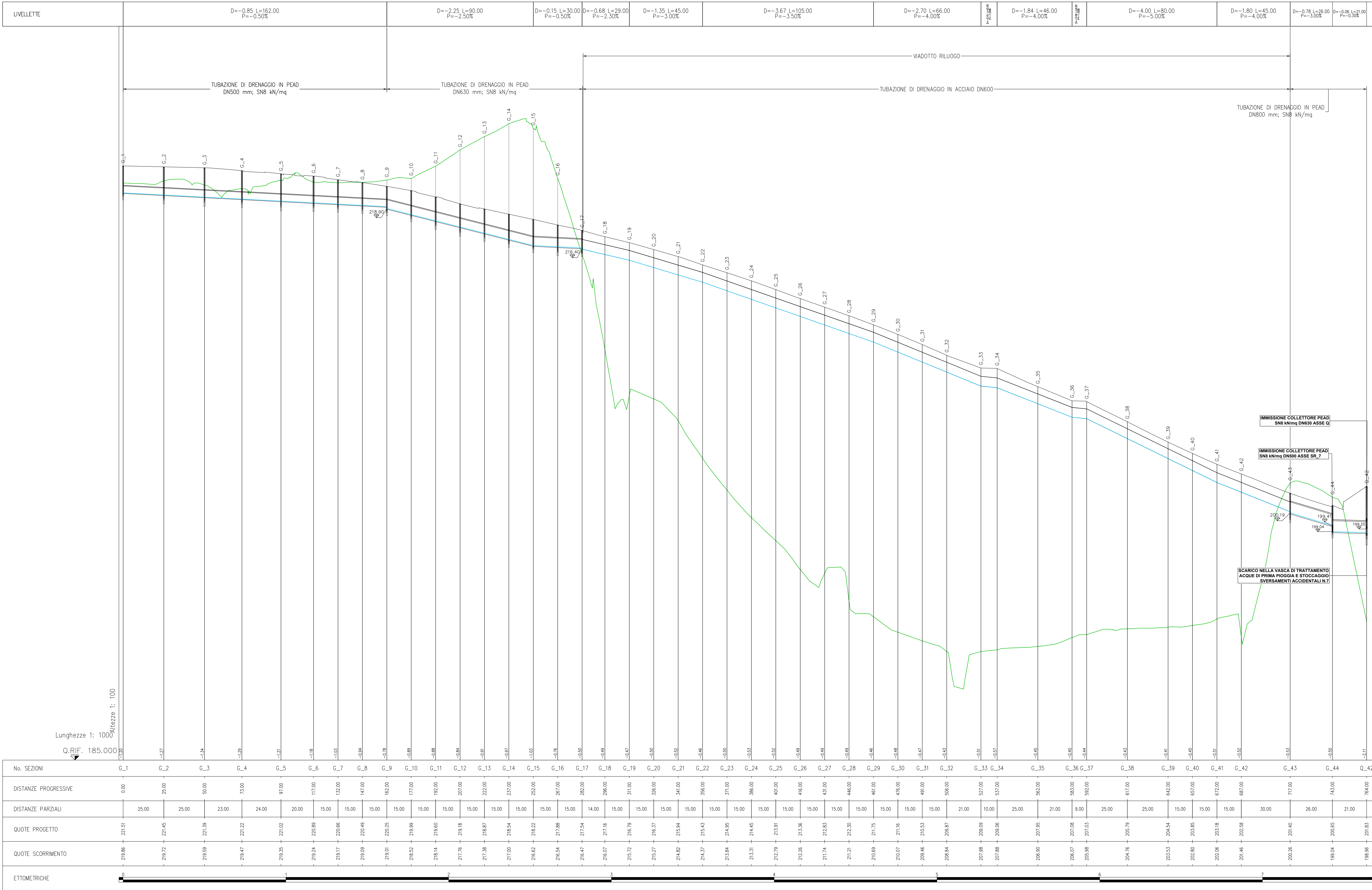
ASSE FANO-GROSSETO PROFILO LONGITUDINALE ASSE G
