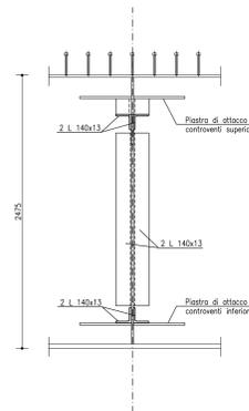
SEZIONE TRASVERSALE SPALLA R2
