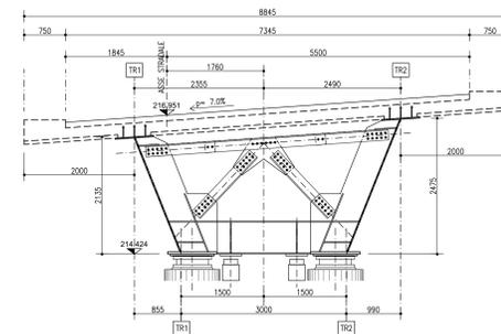
SEZIONE TRASVERSALE PILA R2
