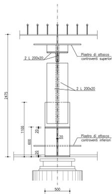
SEZIONE TRASVERSALE PILA R1
