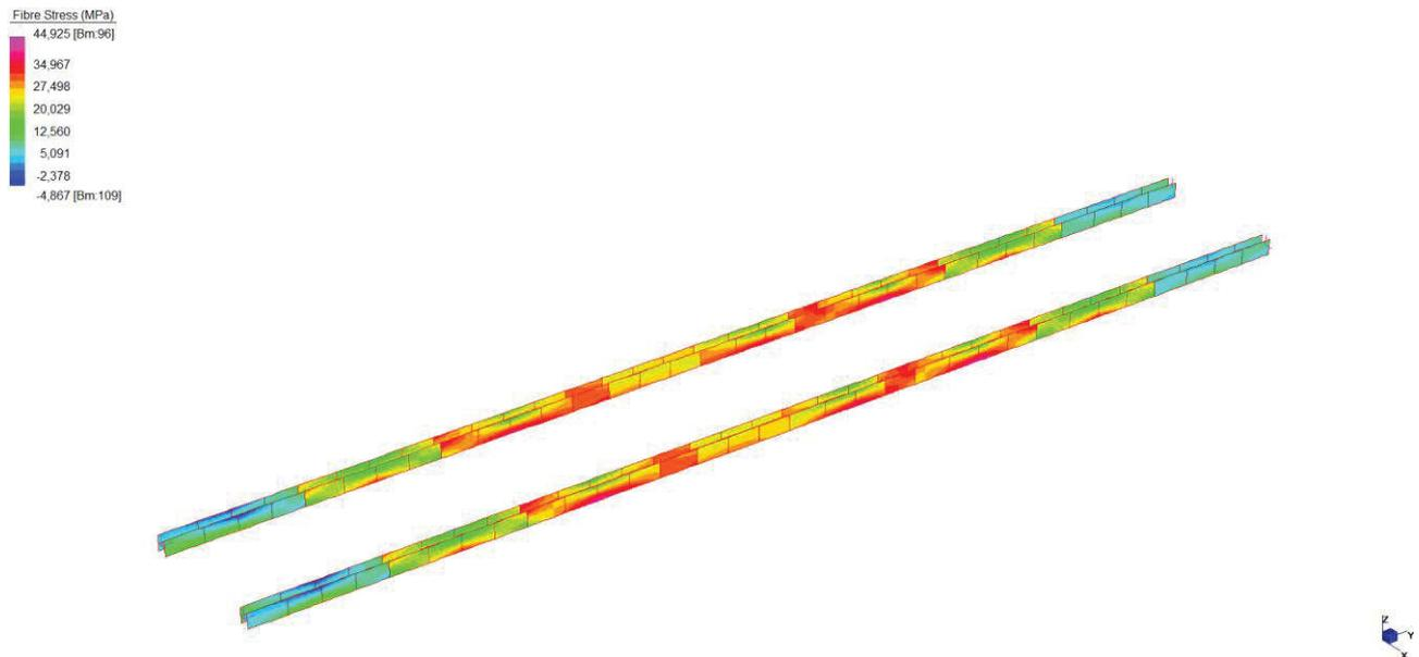
Figura 41: tensioni massime nel corrente inferiore per carichi a fatica
