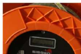
Figura 12 – Esempio di freatimetro.
