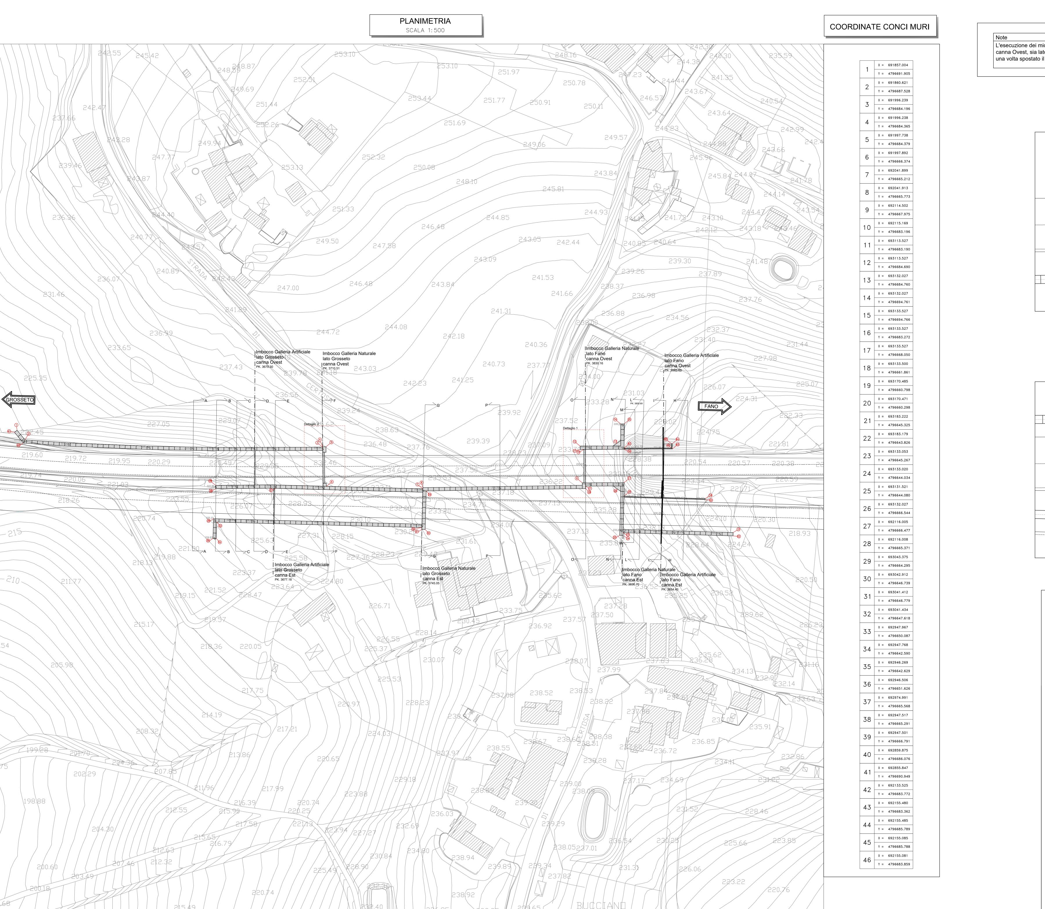
L'esecuzione dei micropali sulla parete d'imbocco in corrispondenza della canna Ovest, sia lato Grosseto che lato Fano, dovranno essere eseguiti una volta spostato il traffico nella canna Est di nuova esecuzione.
