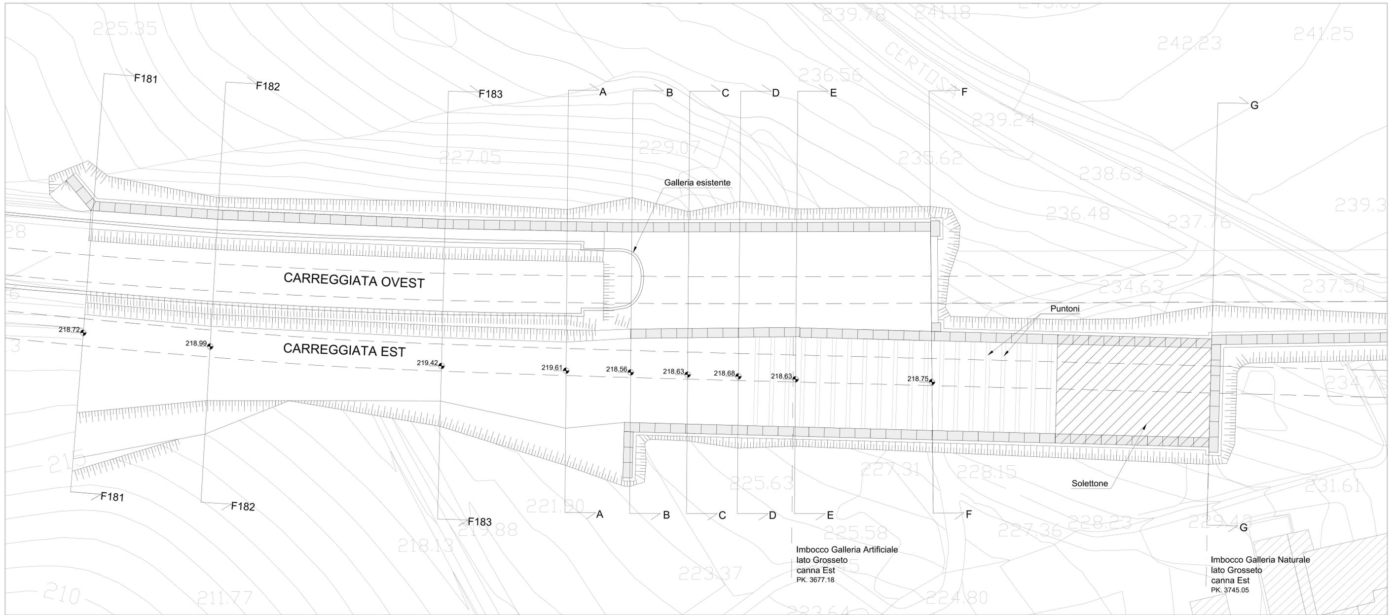
NOTA: I diaframmi in c.a. lato monte della carreggiata Ovest potranno essere eseguiti una volta dismessa la galleria esistente, con trasferimento del traffico veicolare sulla nuova carreggiata Est.
