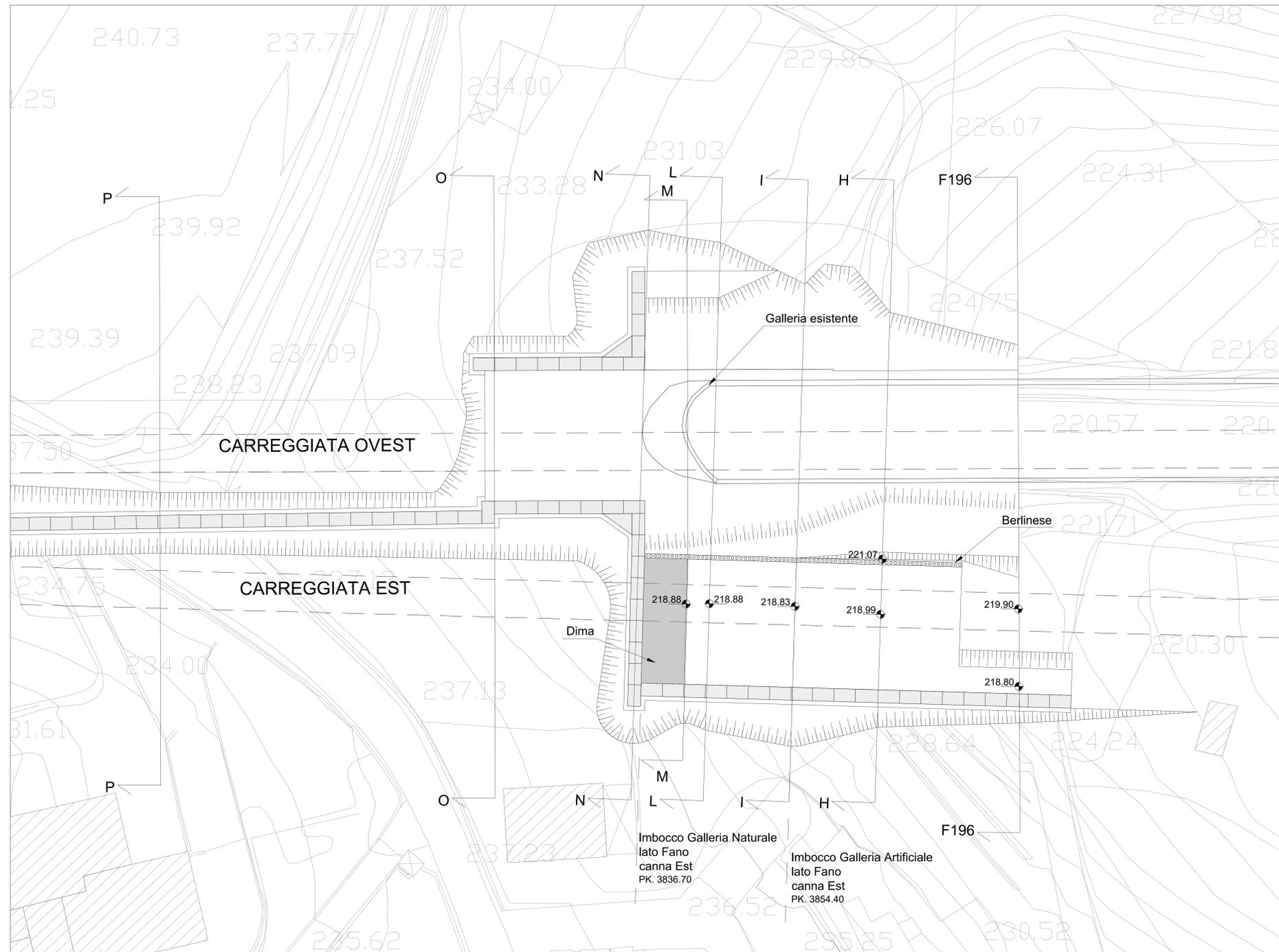
NOTA: I diaframmi in c.a. lato monte della carreggiata Ovest potranno essere eseguiti una volta dismessa la galleria esistente, con trasferimento del traffico veicolare sulla nuova carreggiata Est.
