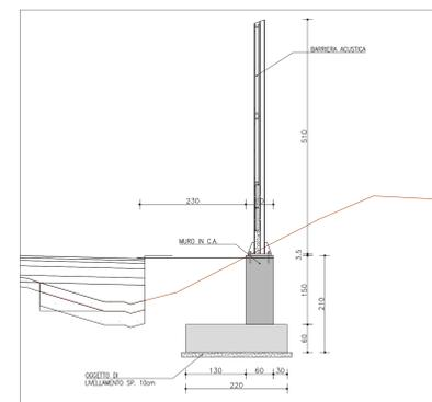
**DETTAGLIO "1" - PROSPETTO TIPO**
