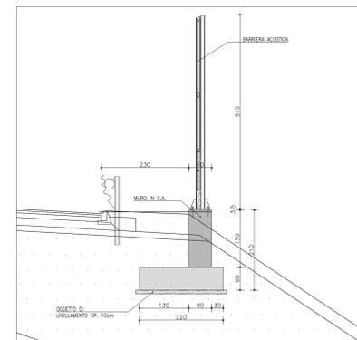
**DETTAGLIO "1" - PIANTA TIPO**
