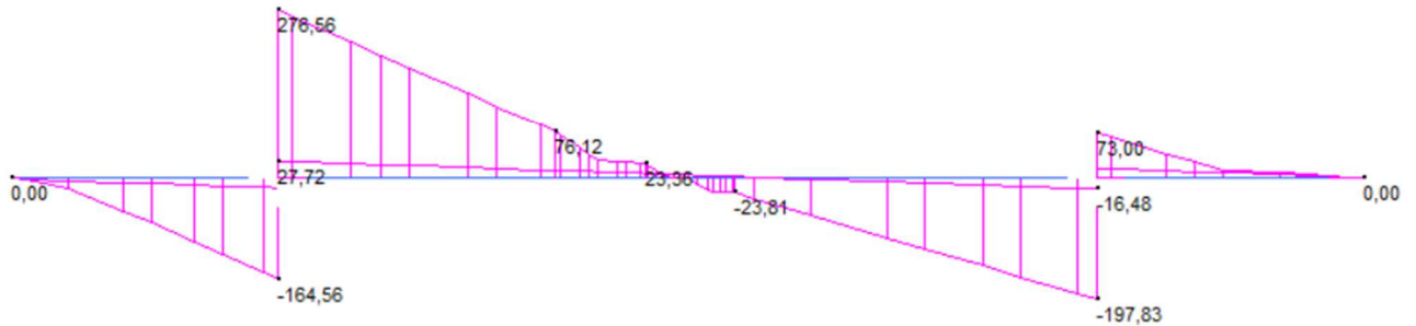
Figura 66 – Involuppo sollecitazioni di taglio SLU (kN)
