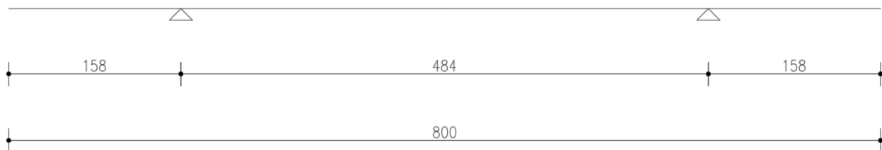
Figura 48 – Schema di calcolo trave continua (cm)
