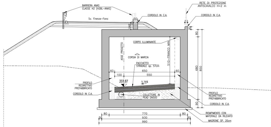
DETTAGLIO PAVIMENTAZIONE STRADALE
