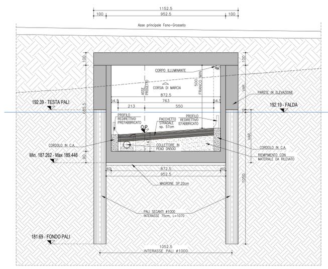
DETTAGLIO PAVIMENTAZIONE STRADALE
