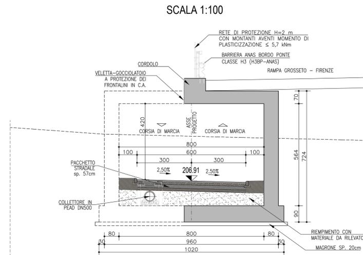
DETTAGLIO CORDOLO MURI PREFABBRICATI CON RETE DI PROTEZIONE ANTISCAVALCO
