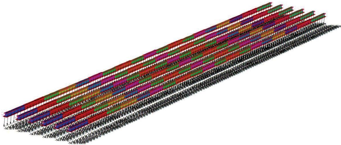
Figura 13: carico del getto liquido della soletta
