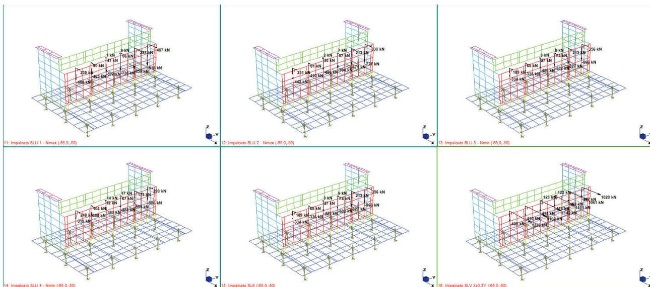
Figura 79: Carichi derivanti dagli appoggi dell'impalcato
