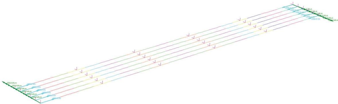
Figura 16: azione della deformazione termica
