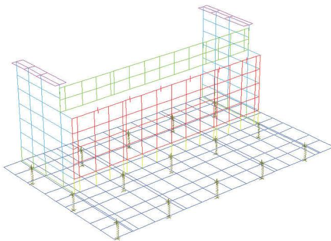
Figura 69: Modello FEM wireframe - Molle nodali
