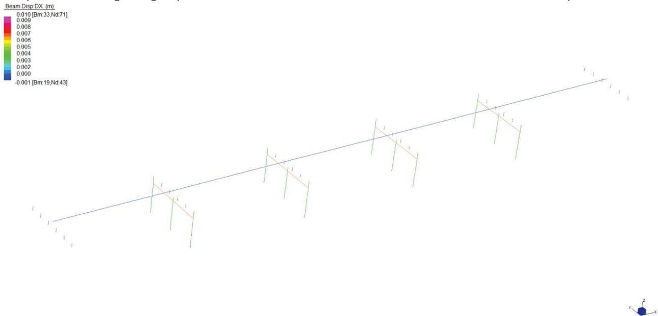
**Figura 46: Spostamenti Appoggi SLV X+0.3Y q=1**
