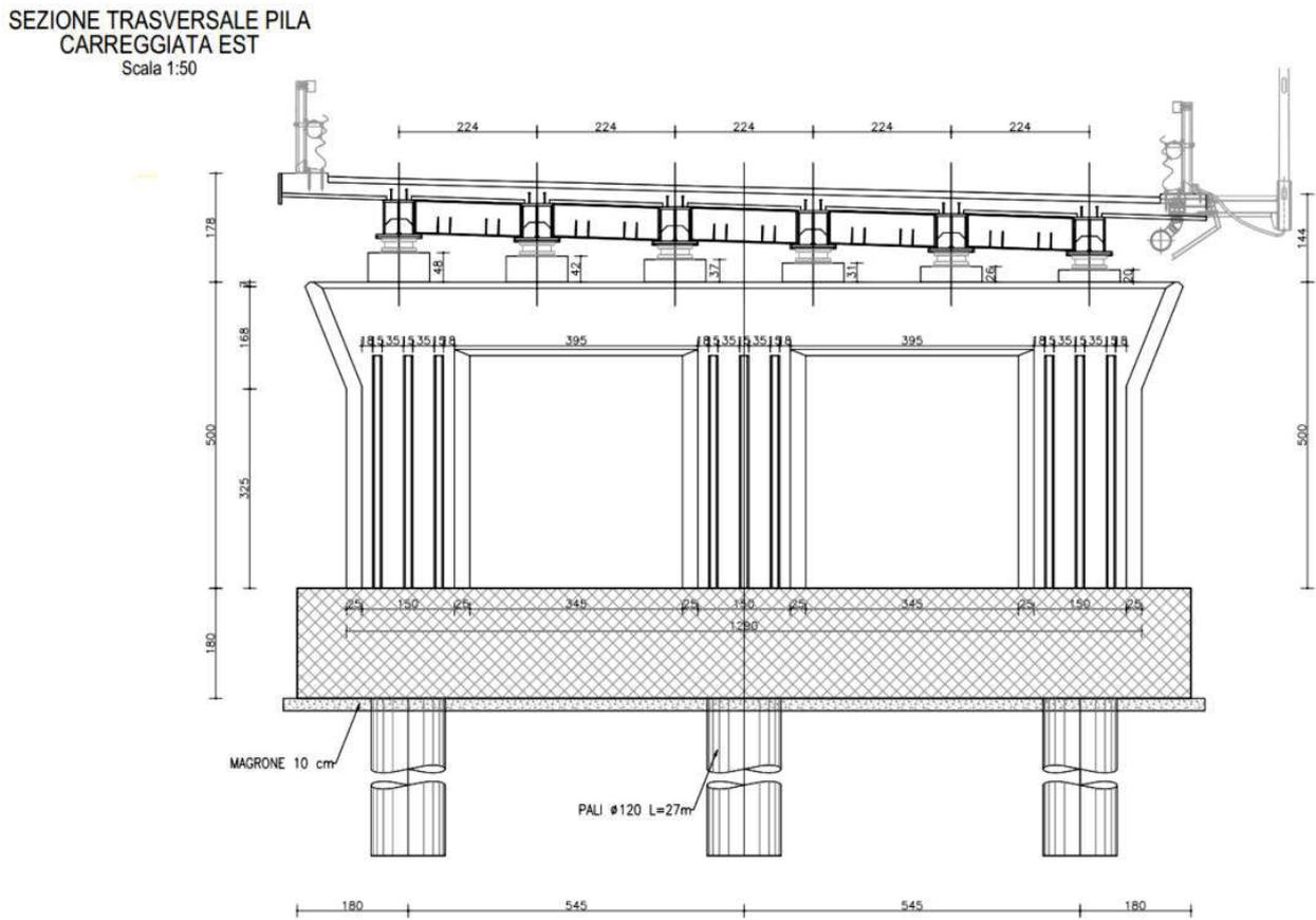
**Figura 4: viste e sezioni principali – sezione trasversale in pila**
