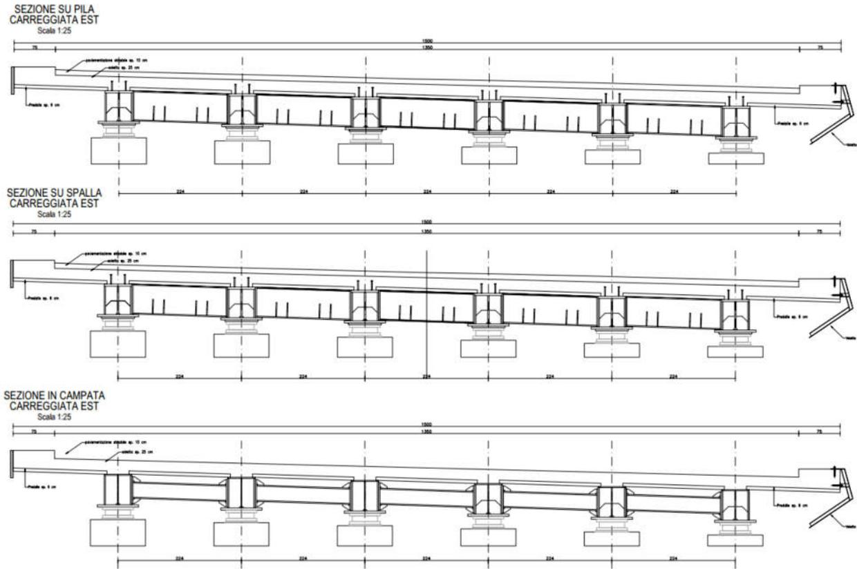
**Figura 3: viste e sezioni principali – sezioni tipologiche impalcato**
