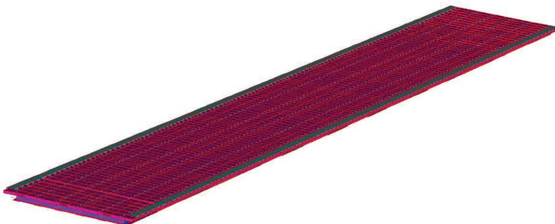
Figura 10: modello di calcolo dell'impalcato – vista globale solida
