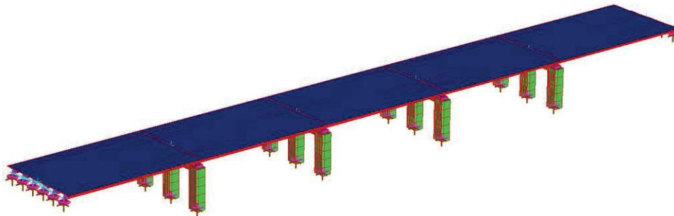
Figura 33: modello FEM sismico
