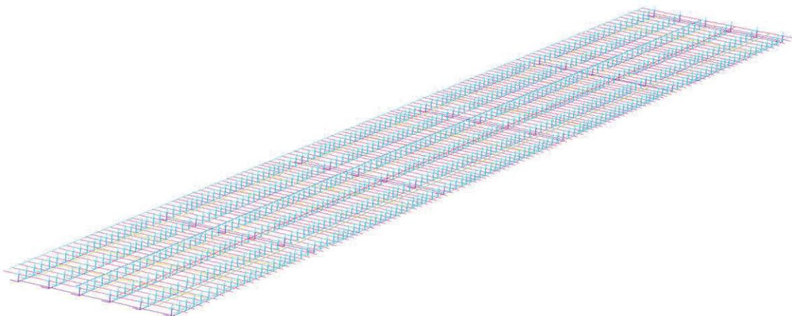
Figura 11: modello di calcolo dell'impalcato – vista globale wireframe
