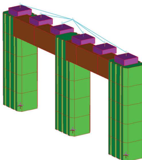
Figura 34: modello FEM sismico – Pila generica
