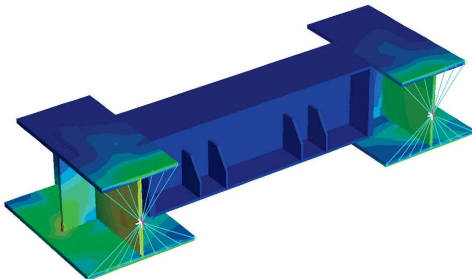
Figura 43: tensioni di Von Mises SLU – traverso di spalla
