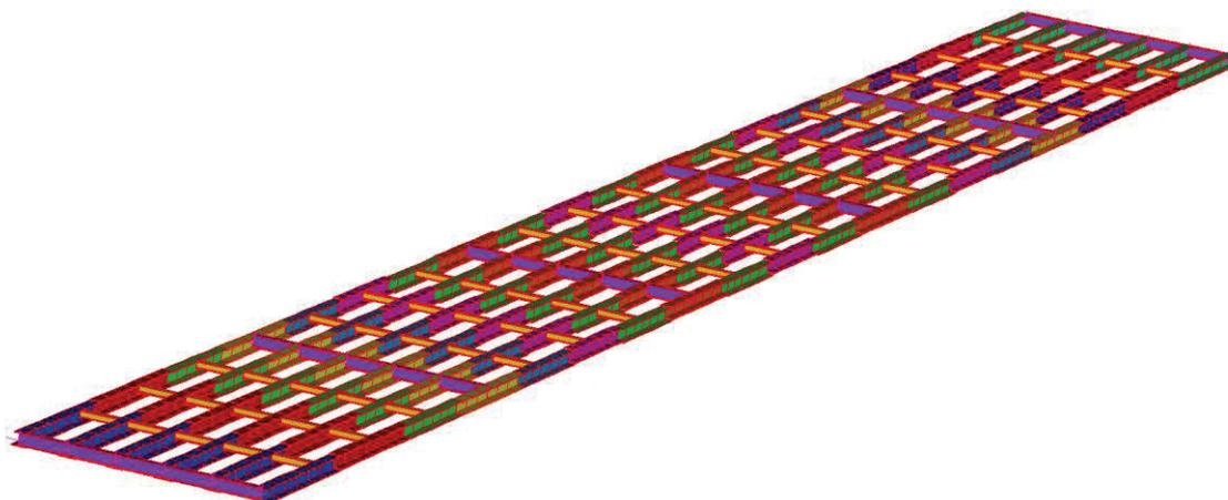
Figura 12: modello di calcolo dell'impalcato – sola struttura metallica
