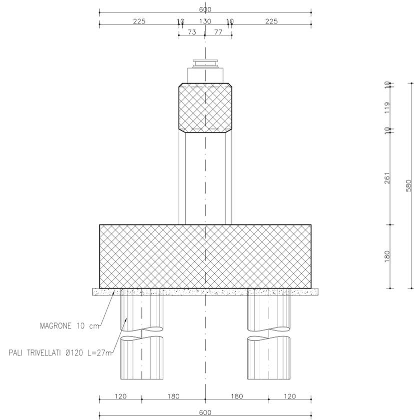
SEZIONE TRASVERSALE PILA
