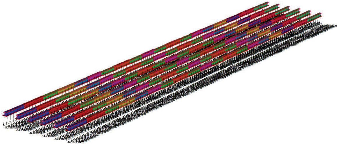
Figura 13: carico del getto liquido della soletta
