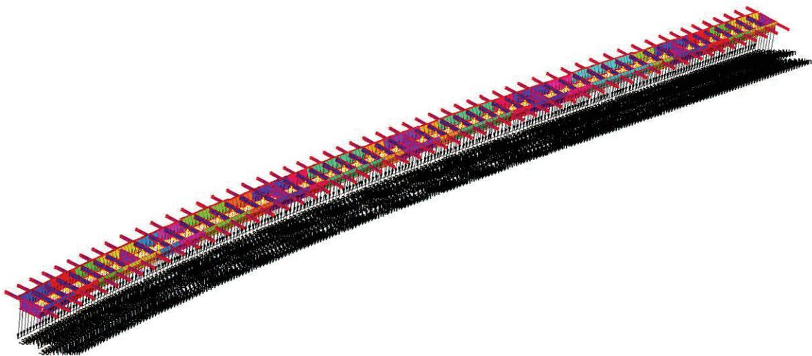
Figura 14: carichi permanenti non strutturali
