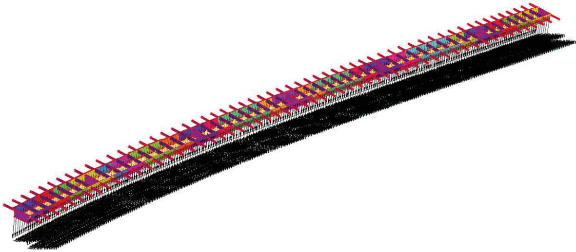
Figura 13: carico del getto liquido della soletta
