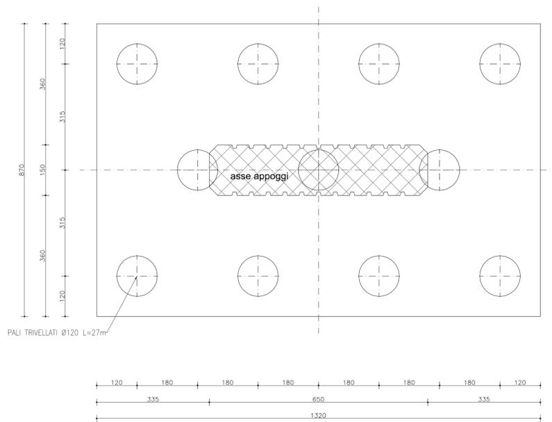
SEZIONE LONGITUDINALE PILA 1
