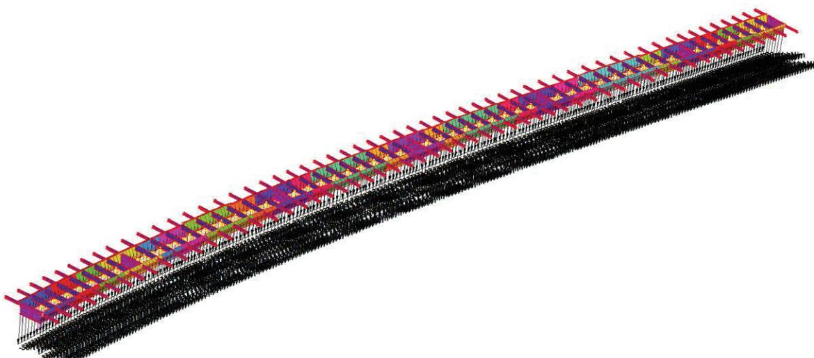
Figura 14: carichi permanenti non strutturali
