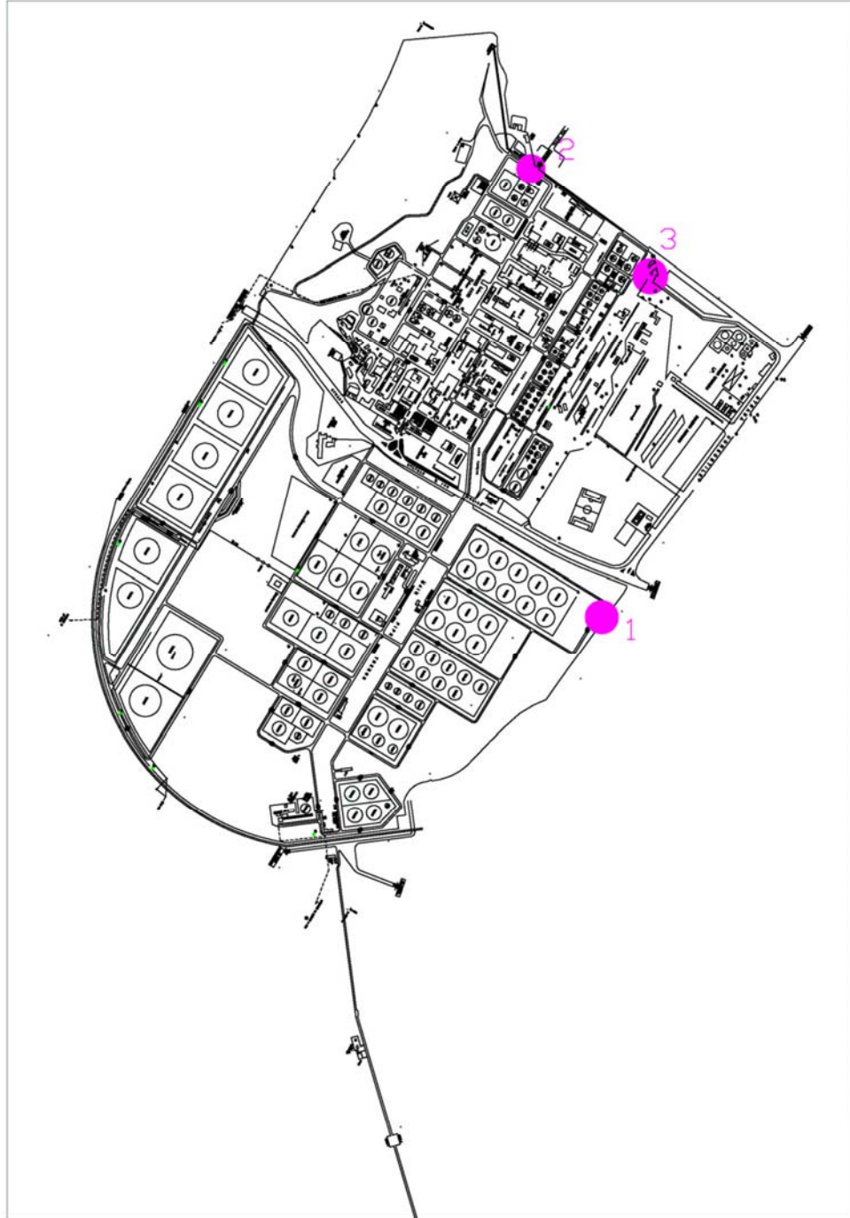
Figura 3.3-A: Posizionamento centraline rilevamento dati atmosferici della Raffineria Eni
