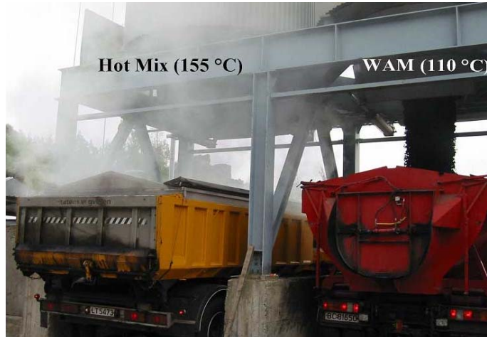
Figura 4: confronto tra conglomerato bituminoso tradizionale e Warm Mix Asphalt in termini di produzione di fumi in impianto
