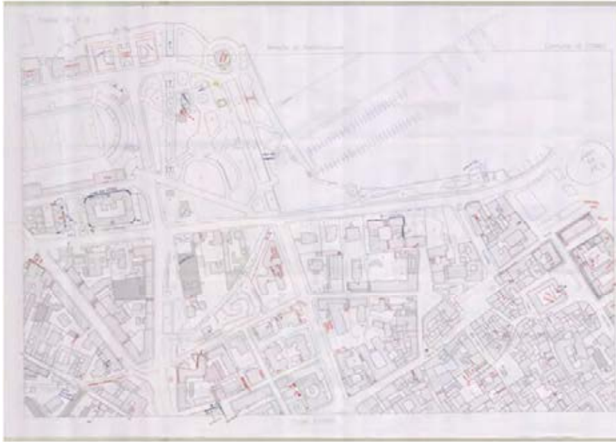
Figura. Esempio di minuta di restituzione con integrazioni di ricognizione
