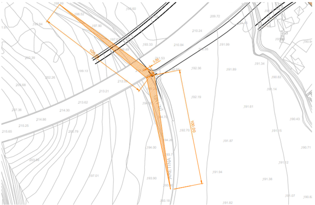
Figura 47 - Verifica visibilità accessi – Secondo caso
