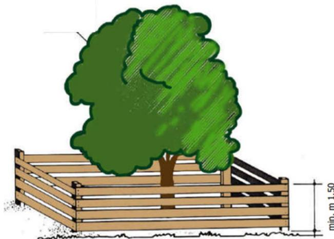
Figura 40 - Tipologico palizzata di protezione alberature
