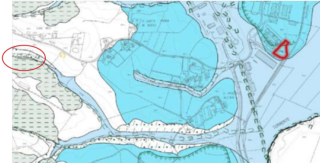
Figura 200 – In giallo localizzazione frana non cartografabile in loc. S.Beci - Stralcio Carta Geomorfologica elab. B.09.02 PSC (Marzo 2020) – in rosso la centrale di betonaggio "Barbetti Materials"
