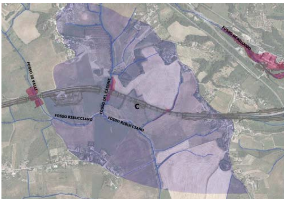
Figura 315 - Tratti fluviali primari e secondari presenti nell'ambito C di intervento, area di indagine (rosso) e tracciato di progetto (grigio)
