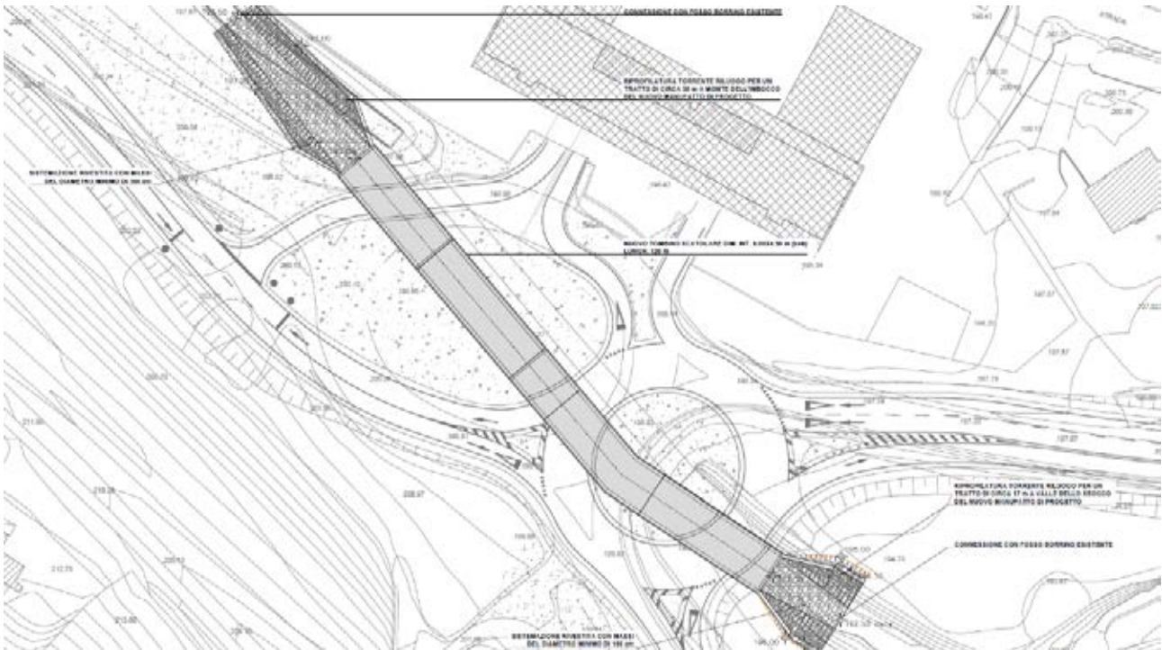
Figura 326 - Riprofilatura del Torrente Riluogo e nuovi manufatti di connessione idraulica al corso esistente
