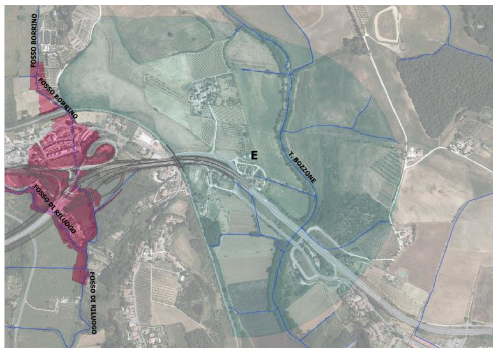
Figura 317 - Tratti fluviali primari e secondari presenti nell'ambito E di intervento e tracciato di progetto in grigio
