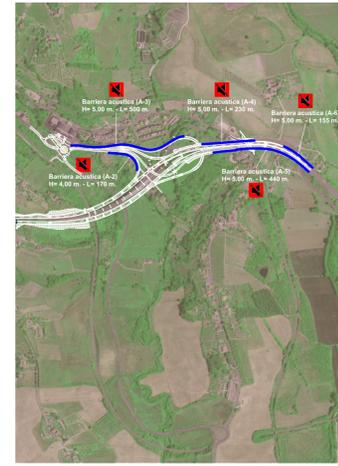
La tipologia di barriera acustica H= 5,00 m. integrata e non, riportata nel seguente elaborato, è da ritenersi valida anche per le barriere H= 4,00 m, composte da 2 metri da pannellatura cieca e 2 metri da pannellatura trasparente
