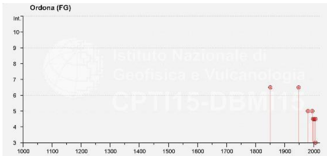
Figura 95 - Grafico illustrante la storia sismica di Ortona. Sulle ascisse sono riportati i riferimenti temporali espressi in anni, sulle ordinate le intensità sismiche (I) degli eventi rilevati (da http://emidius.mi.ingv.it/CPTI15-DBMI15/ ).
