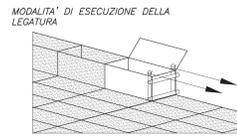
FISSARE UN TELAIO ALL'ULTIMO GABBIONE DELLA FILA DA RIEMPIRE, IN MODO DA POTERE ESERCITARE UNA TRAZIONE SU DI ESSA ANCORANDOLA AD UN PUNTO FISSO. L'ULTIMO GABBIONE NON VERRA' RIEMPIUTO FINO A QUANDO NON SARA' STATO FISSATO A QUELLO APPARTENENTE ALLA NUOVA SERIE DI UNITA' DA METTERE IN OPERA
