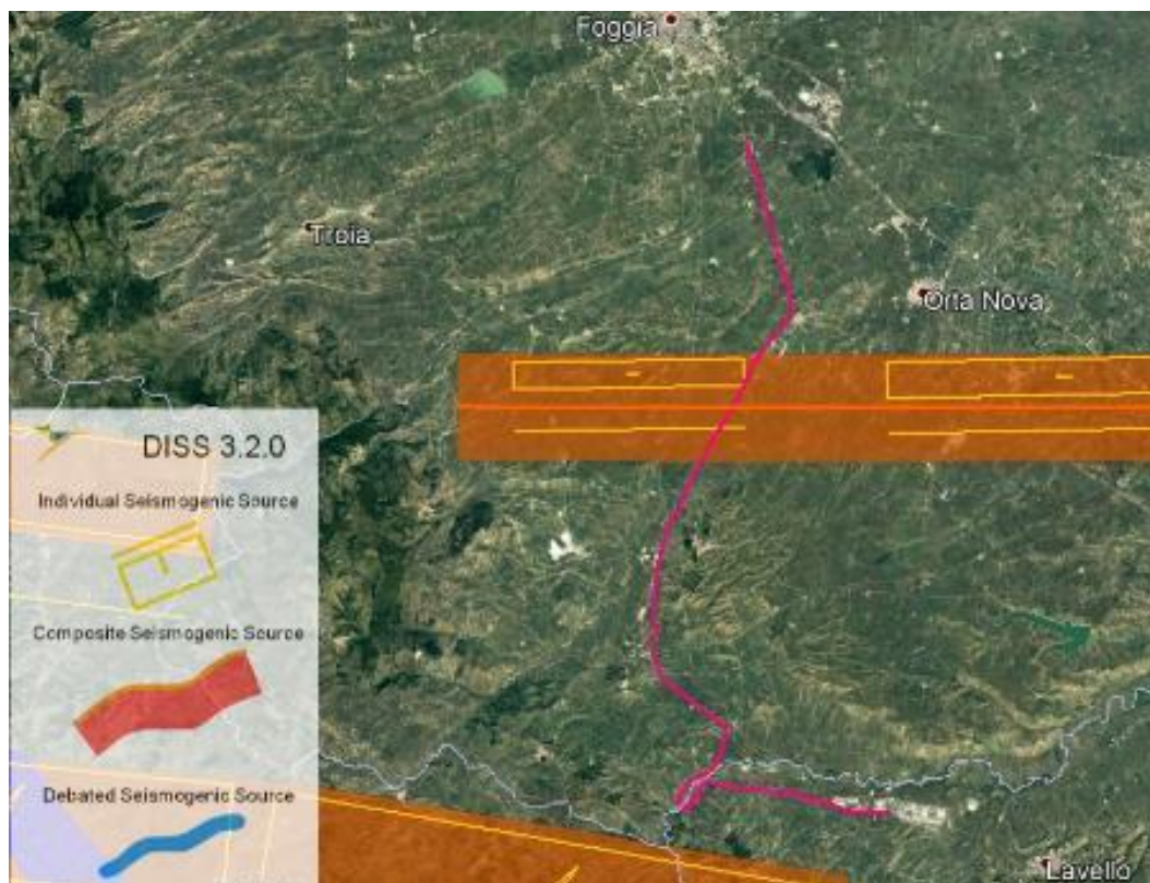
Figura 87 - Localizzazione delle potenziali sorgenti di terremoti con M > 5.5 nell'area di studio (da DISS Working Group 2015, Database of Individual Seismogenic Sources (DISS), versione 3.2.0., http://diss.rm.ingv.it/diss/index.html ).
