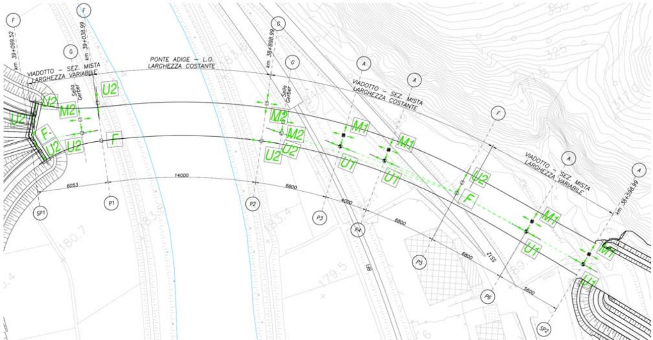
Figura 7.22 – Schema planimetrico appoggi
