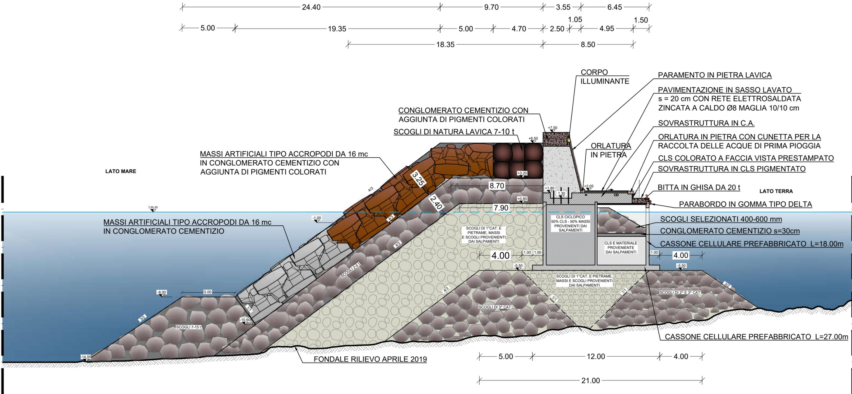
SEZIONE TESTATA SOPRAFLUTTO - scala 1:200
