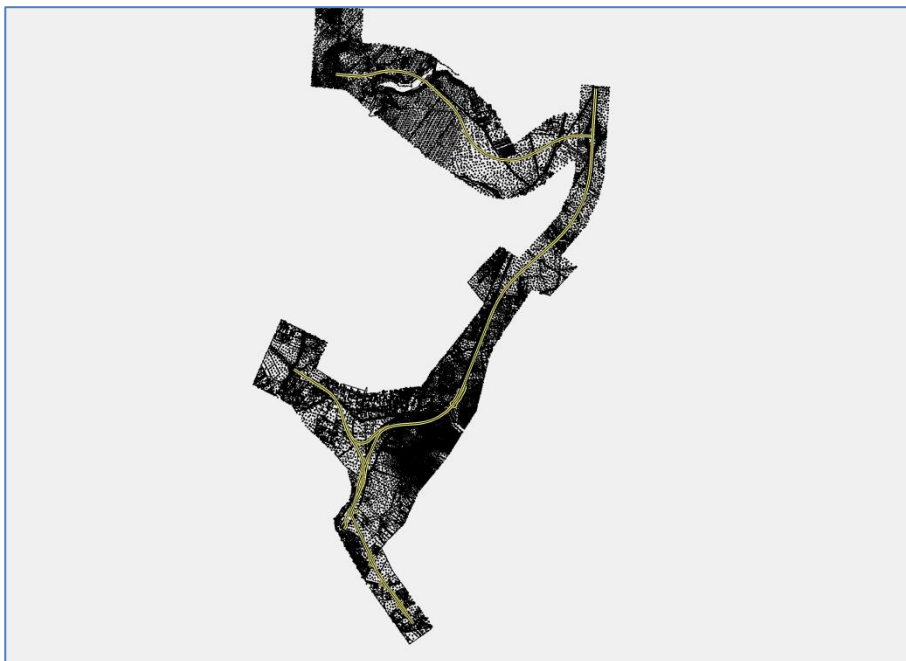
Figura 10 - Rappresentazione 2D della nuvola di punti e l'insieme di linee provenienti dal rilievo celerimetrico di scala sia relativamente al Lotto 1 sia al Lotto 4.
