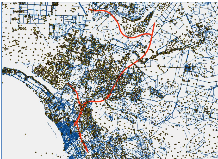
Figura 8 - Rappresentazione 2D della nuvola di punti e l'insieme di linee provenienti dal DBGT 10.000.
