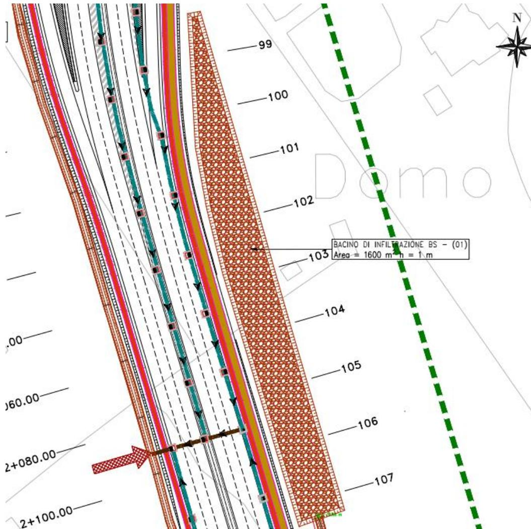
Figura 44 - Ubicazione planimetrica bacino di infiltrazione BS - (01)
