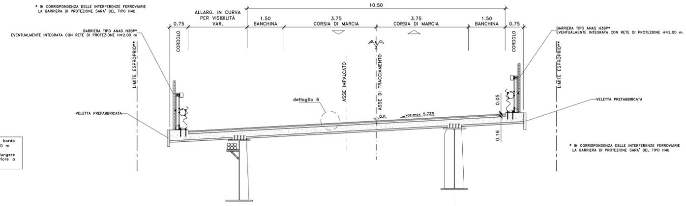
(\*\*) Limite esproprio 2.00 m oltre il bordo dell'impalcato per viadotti di altezza <10.00 m. Per viadotti di altezza >10.00 m aggiungere 1.00 m per ogni metro di altezza superiore a 10.00 m per un massimo di 12.00 m
