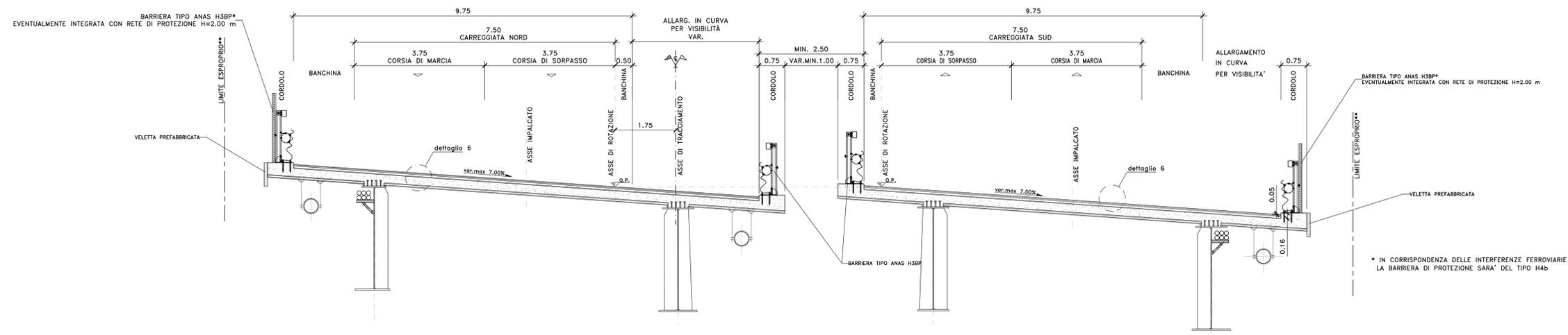
\* IN CORRISPONDENZA DELLE INTERFERENZE FERROVIARIE LA BARRIERA DI PROTEZIONE SARA' DEL TIPO H4b
