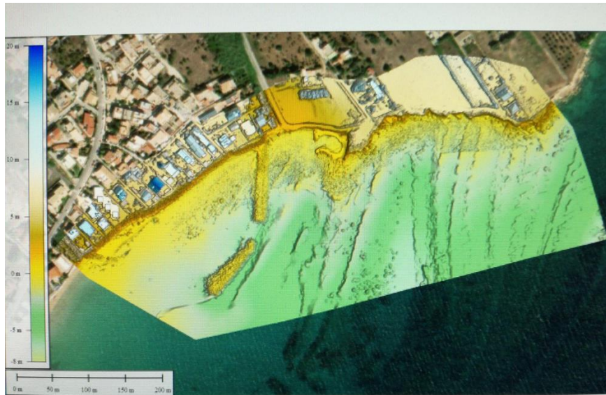
Figura 43 – Avola (ME): modello di elevazione digitale (DEM) generato dalla lebaorazione dei dati batimetrici (maglia di acquisizione maglia 0,25x0,25 m e riportato su GIS insieme all'ortofoto dell'area di indagine.
