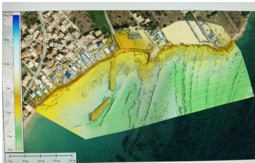
Figura 44 – Avola (ME): Linee di navigazione eseguite per l'acquisizione dei dati batimetrici Mbes a copertura completa.
