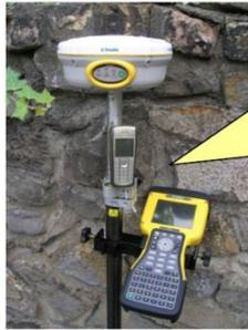
E' necessario disporre di un "kit rover NRTK" costituito da un ricevitore geodetico a doppia frequenza, configurato come rover, e un modem telefonico GSM/GPRS (spesso integrato nel ricevitore o nel controller) per la trasmissione del messaggio NMEA e la ricezione delle correzioni RTCM (o CMR, ...)
