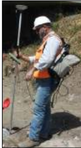
Figura 3-3- Strumentazione utilizzata per la georeferenziazione dei punti di sondaggio
