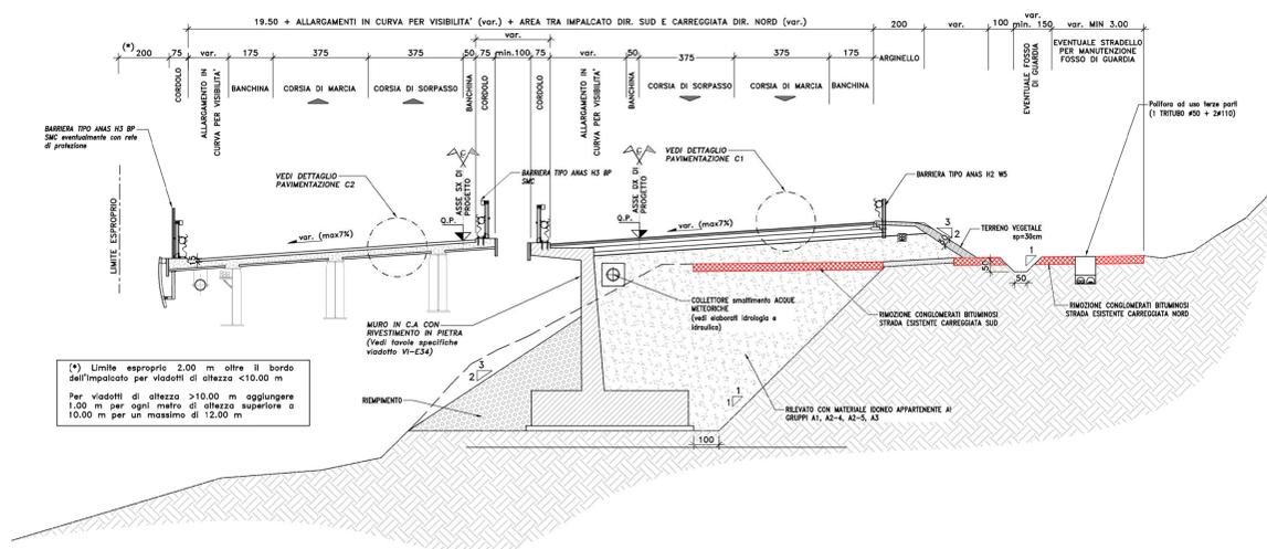
(\*) Limite esproprio 2,00 m oltre il bordo dell'impalcato per viadotti di altezza <10,00 m. Per viadotti di altezza >10,00 m aggiungere 1,00 m per ogni metro di altezza superiore a 10,00 m per un massimo di 12,00 m.
