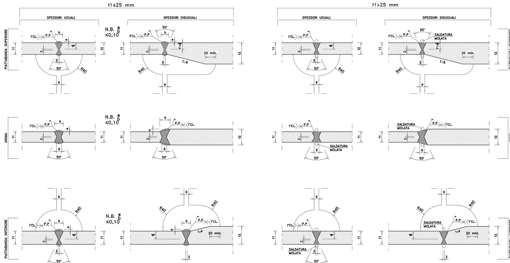
PARTICOLARE ESECUZIONE SALDATURE PIASTRE IMPILATE
