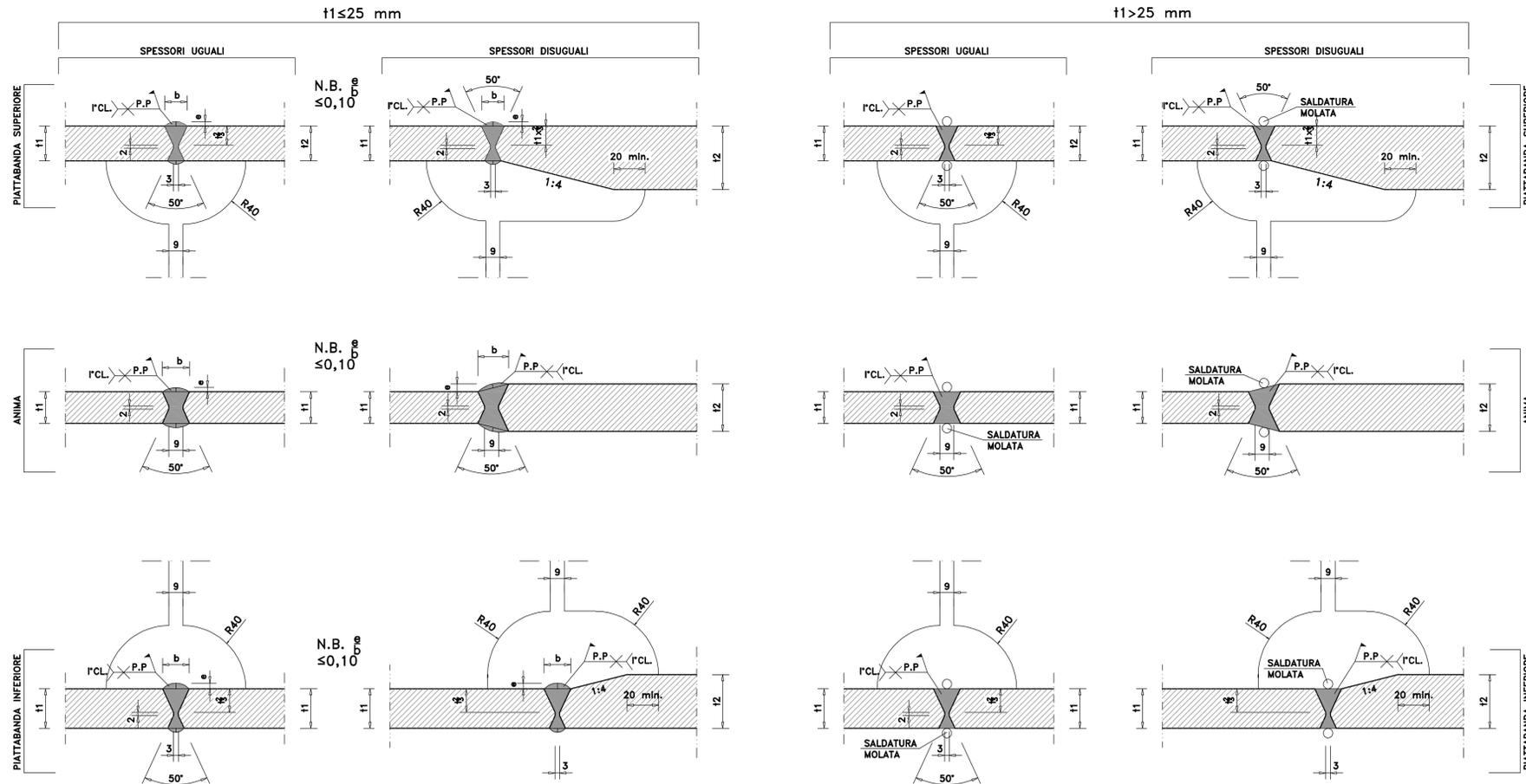
PARTICOLARE ESECUZIONE SALDATURE PIASTRE IMPILATE
